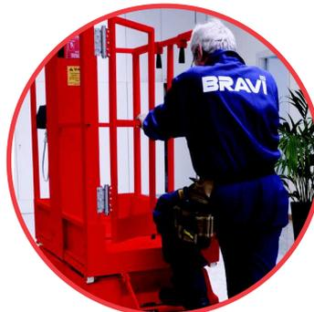
Dank einer Radsperrung können Sie auf einer geraden Linie vor- und rückwärts fahren, wenn Sie enge Gänge ansteuern. Neue Gittertür ermöglicht eine bessere Eintritt auf die Bühne.
